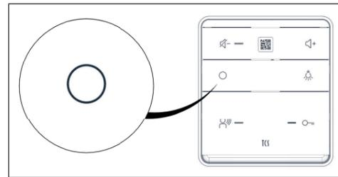
Nutzen Sie den manuellen Konfigurationsmodus, wenn ein neues TCS-DECT Endgerät hinzugefügt werden soll.
