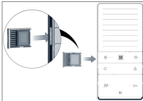
Die Ambientebeleuchtung leuchtet kurz grün. Der Smart Stick DECT wurde erkannt. Der Smart Stick DECT geht automatisch in den Konfigurationsmodus. Die Ambientebeleuchtung blinkt orange.
