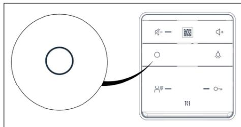
Der Smart Stick schaltet in den Konfigurationsmodus und gibt seinen WLAN Access Point frei.
