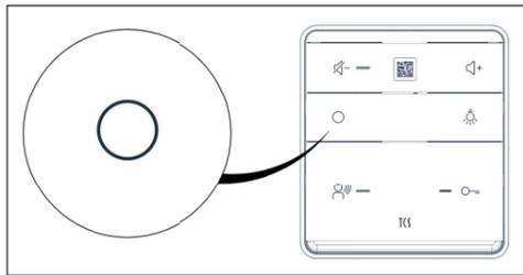
Leuchtet die LED der Sprechentaste **grün**, kann der Smart Stick in der Innenstation **verwendet** werden.
